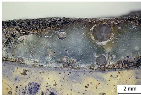
Obr. 10. Nábrus vzorku č. 1994, nehomogenní charakter vrstvy zelenomodré barvy, v dolní části snímku je patrná tavicí pánev.
