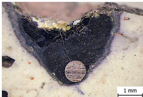
Obr. 11. Nábrus vzorku č. 1992, patrné zbytky modrého skla a kovová inkluze.
