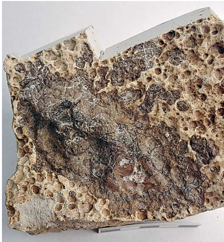
Obr. 15. Detail z předchozího obrázku se zbytky skla; patrná dvě místa odběru (tab. 9, analýzy č. 2000 a 2001). Fig. 15. Detail from fig. 14 with residues of glass; two collection sampling points visible (tab. 1, analysis nos. 2000 and 2001).
