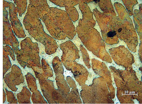
Obr. 7. Náramek A3 – detail dendritické struktury materiálu. 1 – tmavá fáze, 2 – světlá fáze.
