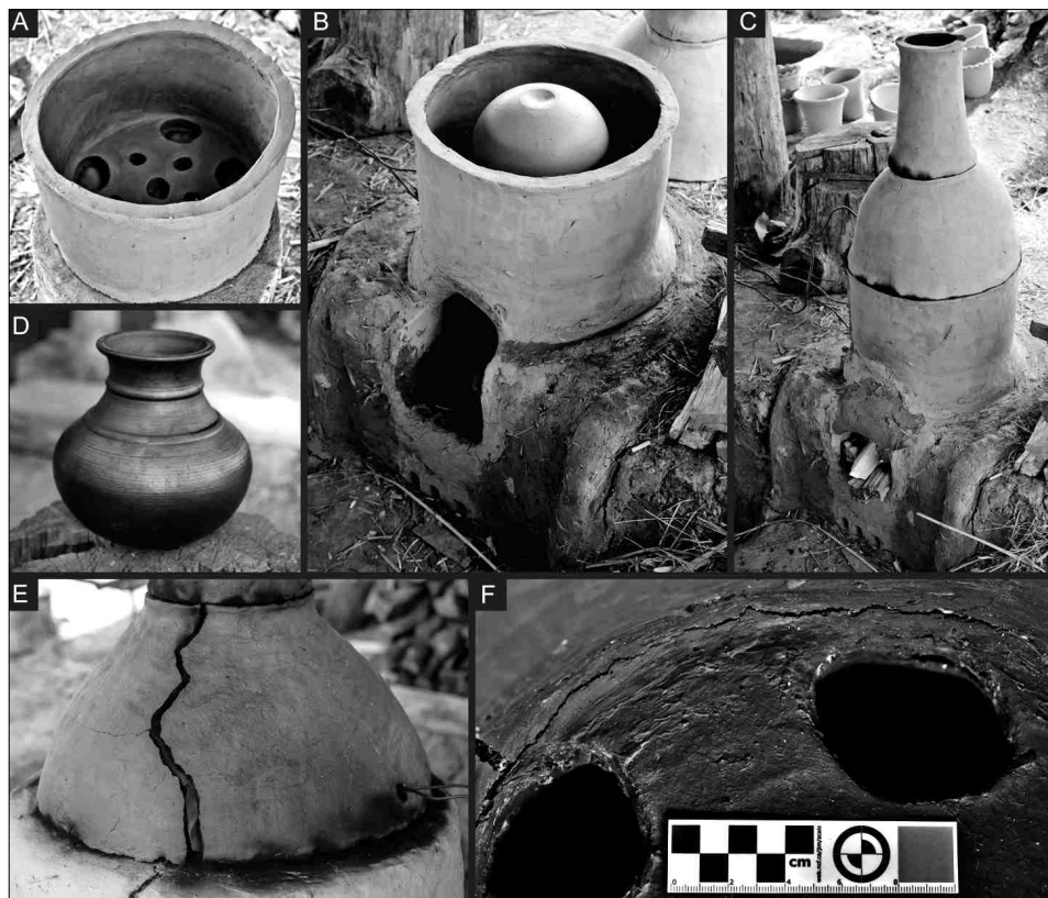
Obr. 14. Fotodokumentace experimentální replikace. A – rošt pece vymodelovaný na rovné podložce spolu s pláštěm spodní části peciště; B – spodní díl pece umístěný nad topeniště s předsušenou nádobou určenou k výpalu; C – kompletní sestava pece v průběhu výpalu; D – vypálená replika časné laténské vytáčené lahve; E – poškození pláště pece v důsledku tepelného namáhání soustavy; F – tmavě šedý povrch interiéru pece po redukčním výpalu.
